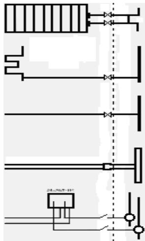
Отопление до первого запорно-регулировочного крана на отводах
