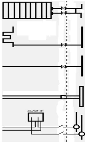
Отопление до первого запорно-регулирующего крана на отводах внутриквартирной разводки от стояков
