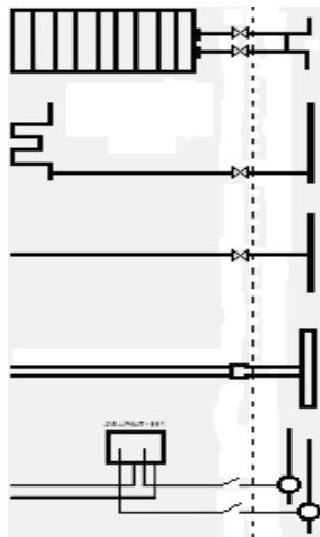
Отопление до первого запорно-регулировочного крана на отводах внутrikвартирной разводки от стояков
