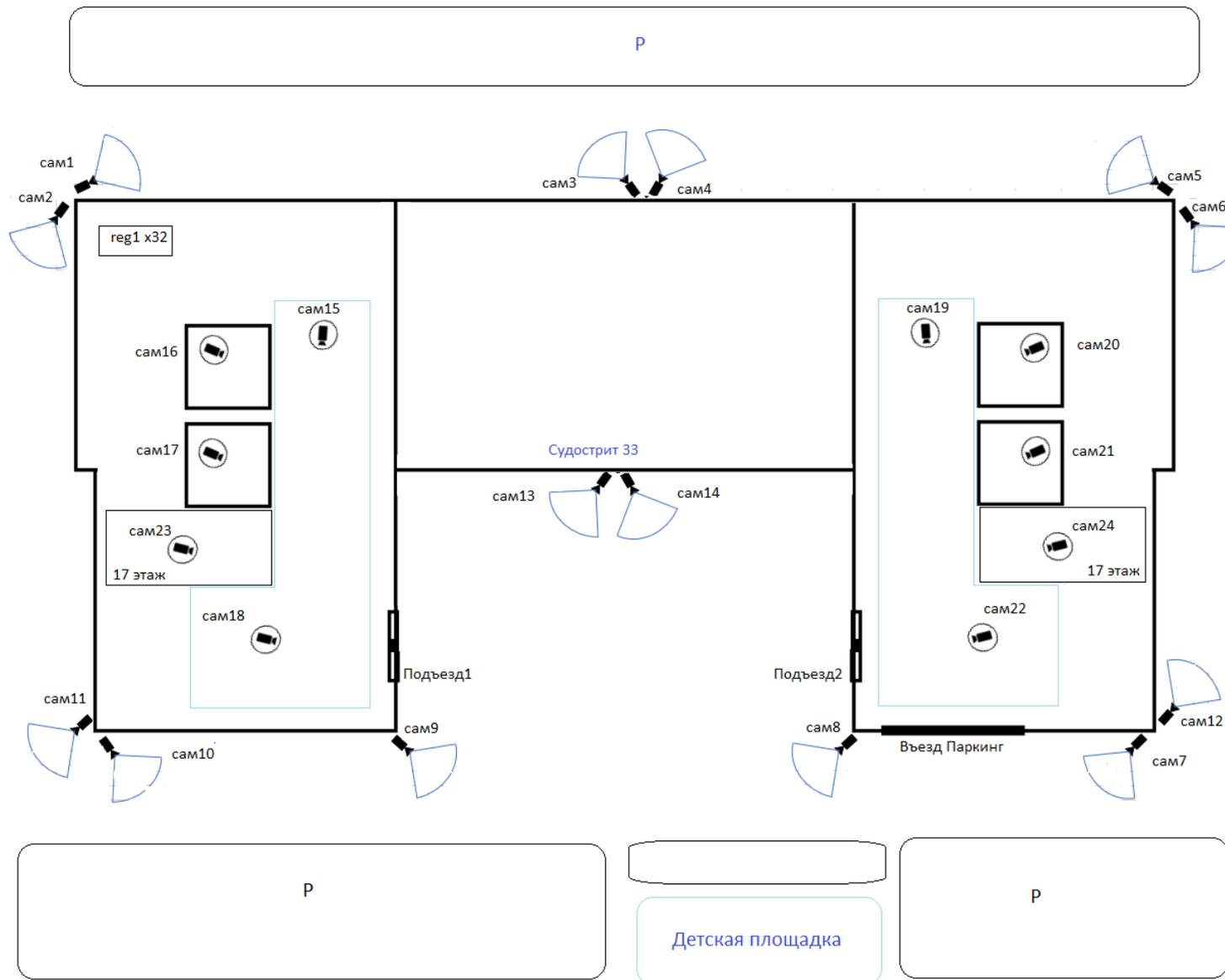
МКД: 32-х канальный регистратор+24 камеры (8 каналов резерв). Паркинг: 16 канальный регистратор +до 16 камер
