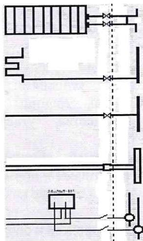
Отопление до первого запорно-регулировочного крана на отводах внутреквартирной разводки от стояков
